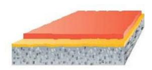
Oberflächenversiegelung Remmers Epoxy OS Beschichtung
